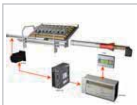
棒材送料設備
