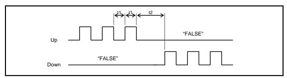
Fig. 5.22 Up & Down Inputs
