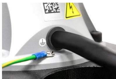
圖 24：固定機器人接地線
