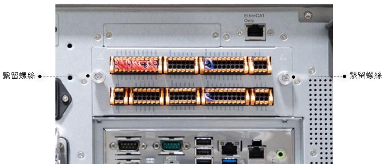
圖 68：拆卸式電控箱 I/O
