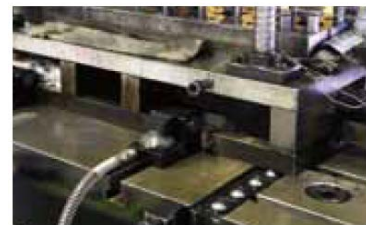
(氣壓浮動式萬向滾珠・舉模器使用例)
